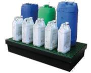
**Le volume du bac de rétention doit être au moins égal à la valeur la plus grande entre : 100% du volume du plus grand réservoir ou à la moitié du volume total des tous les réservoirs rassemblés dans le même bac.**
